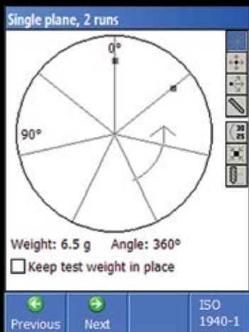
Wyważanie dynamiczne w jednej płaszczyźnie, zgodnie z ISO 1940-1
